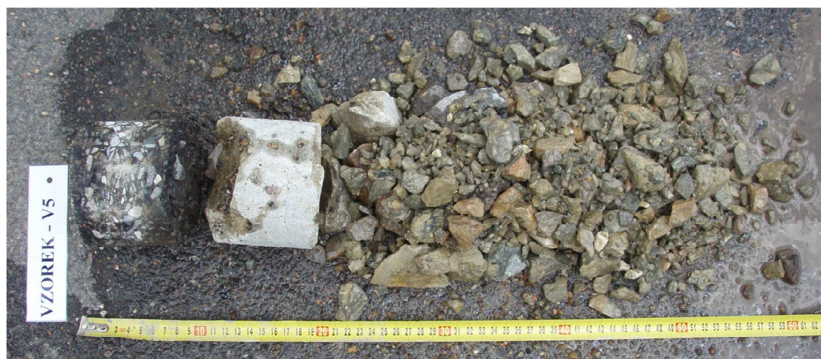
Obr. 9 - Jádro vývrtu Vzorek – V5 (in situ).
