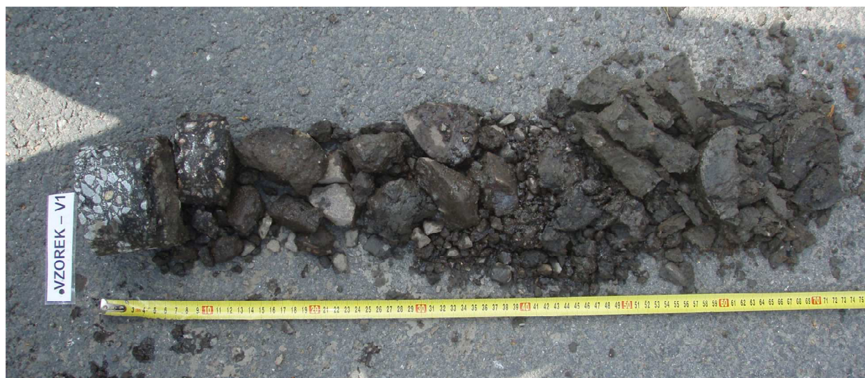
Obr. 1 - Jádro vývrtu Vzorek – V1 (in situ).
