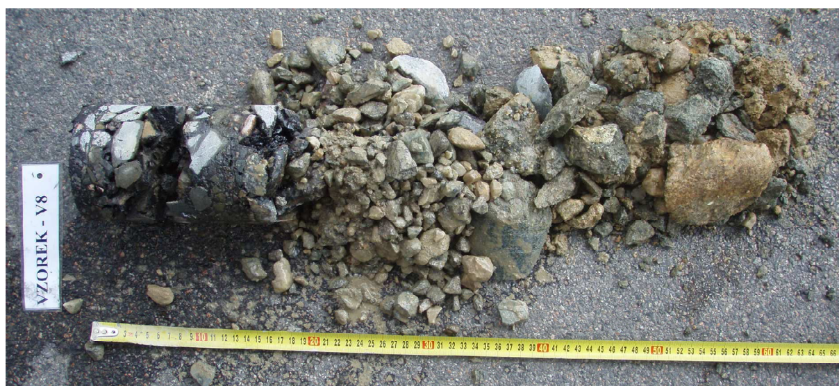
Obr. 15 - Jádro vývrtu Vzorek – V8 (in situ).
