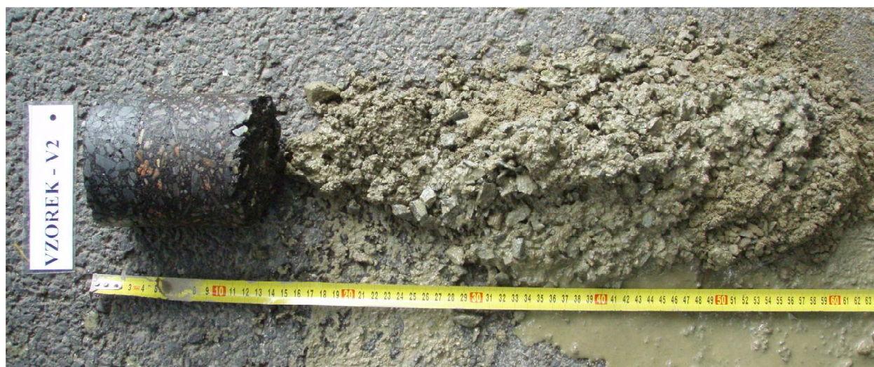
Obr. 3 - Jádro vývrtu Vzorek – V2 (in situ).
