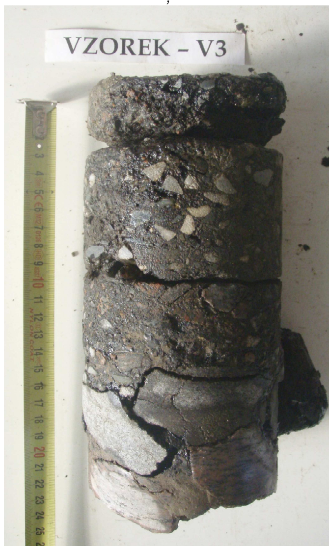
Obr. 6 - Jádru vývrtu Vzorek – V3 (laboratoř).
