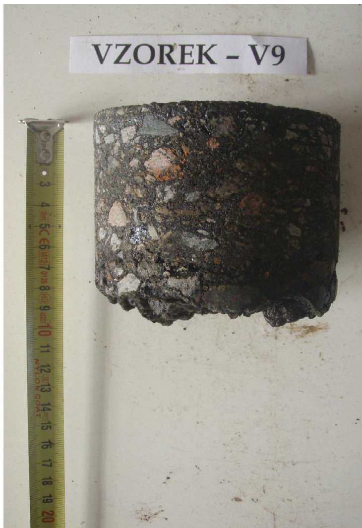
Obr. 18 - Jádro vývrtu Vzorek – V9 (laboratoř).
