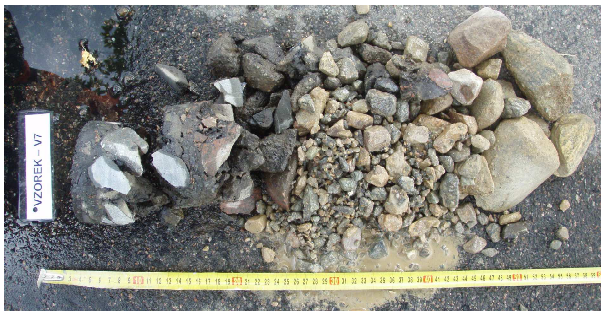
Obr. 13 - Jádro vývrtu Vzorek – V7 (in situ).
