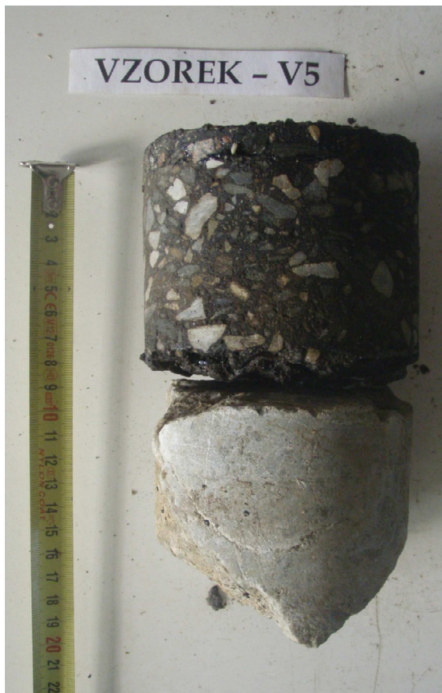
Obr. 10 - Jádro vývrtu Vzorek – V5 (laboratoř).
