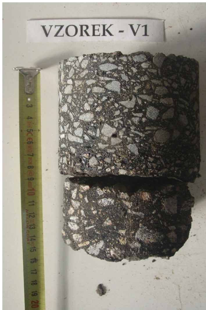
Obr. 2 - Jádru vývrtu Vzorek – V1 (laboratoř).
